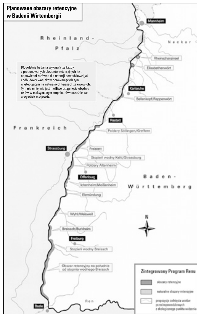
Planowane powierzchnie retencyjne w Badenii-Wirtembergii będą mogły docelowo przejąć wielką wodę o okresie powtarzalności 200-220 lat. Źródło: The Integrated Rhine Programm. Flood control and restoration of former flood plains on the Upper Rhine. Gewässerdirektion Südlicher Oberrhein/Hochrhein, 1997
